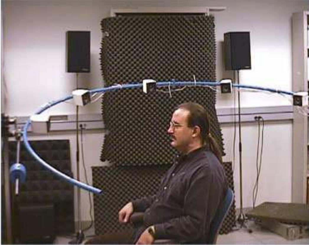
FIG. 14: *Système de mesure de HRIR d'un sujet humain pour la base de HRIR CIPIC.*
