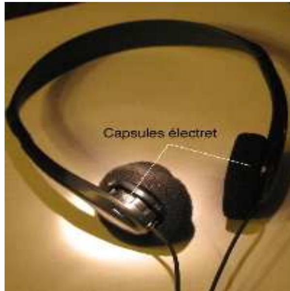
FIG. 47: Le “phonocasque” utilisé pour l’enregistrement des signaux binauraux : casque standard avec des capsules de microphone insérés.
