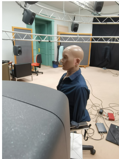
FIGURE 8.9 – Exemple d'enregistrement effectué pour les tests d'indépendance de la distance dans le studio du SCRIME. Ici pour une distance d = 2\text{m} et un azimuth \theta = 0^\circ .
