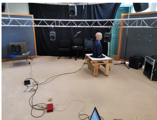
FIGURE 9.7 – Mise en place expérimentale pour la prise de mesures des ILDs au sein du dôme du SCRIME.
