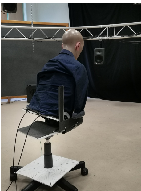
FIGURE 8.3 – Inclinaison du mannequin pour simuler l'élévation (ici 40^\circ ).
