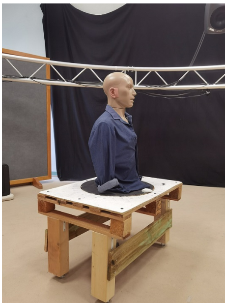
FIGURE 11.16 – Premier système de prises de mesure par le mannequin KEMAR, constitué d'une structure en bois, avec un axe de rotation et des roues pour le déplacement.
