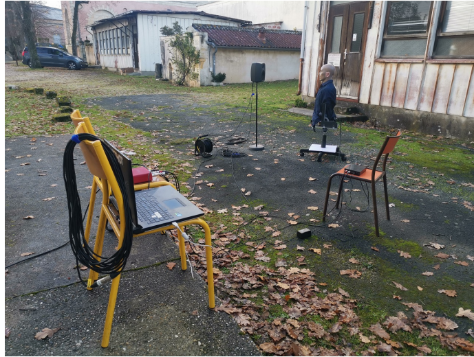
FIGURE 8.8 – Exemple des tests d'enregistrement dans des conditions extérieures (ici pour un azimuth \theta = 80^\circ et une distance d = 2\text{m} ).
