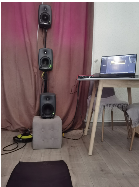
FIGURE 11.3 – Montage expérimental pour la vérification de la spatialisation de l'élévation avec les méthodes VBAP et STAR couplées lors de l'utilisation de configurations avec plusieurs couronnes de haut-parleurs. (Ici chaque couronne est représentée par un seul haut-parleur).
