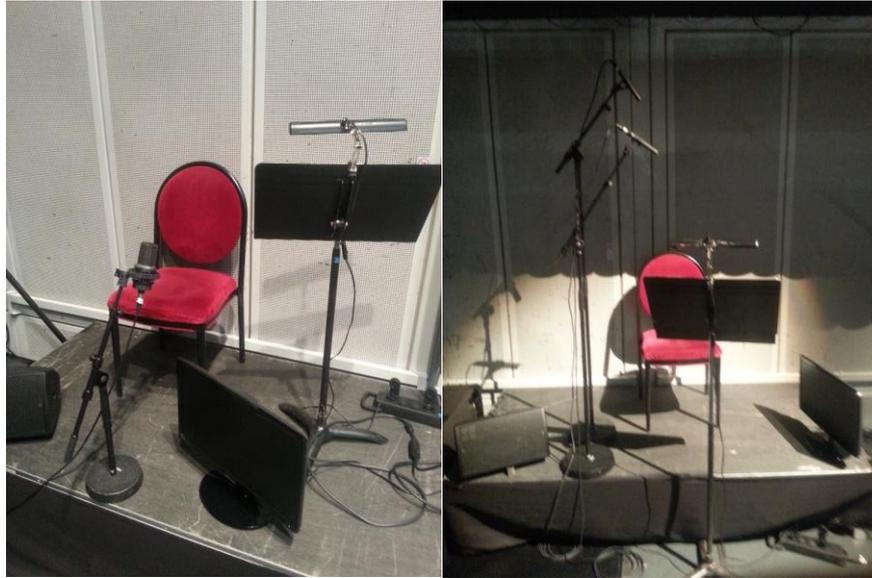
**Figure 2. Microphones d'appoint à proximité de chaque source acoustique potentielle dans l'Espace de Projection de l'IRCAM à Paris.**
