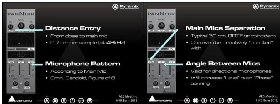
Figure 6. Paramètres d'ajustement pendant le mixage par le plugin VST PanNoir.
