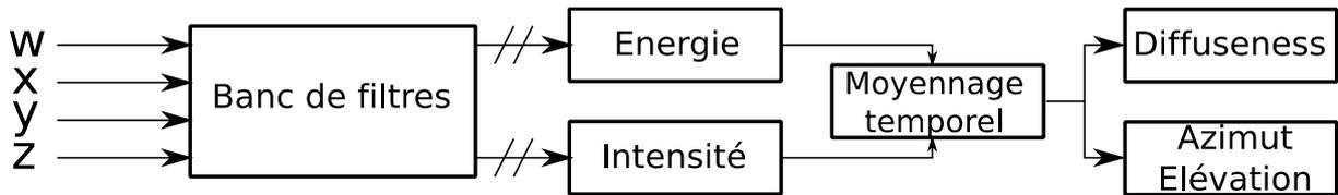
Figure 29. Analyse DirAC. B-format à l'entrée. En sortie du système les paramètres estimés : azimut, élévation et diffusivité.
