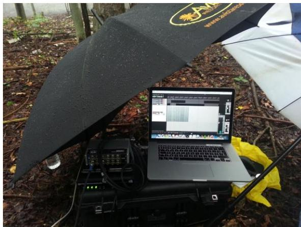
Figure 18. Système de prise de son HOA pendant le tournage au Canada.
