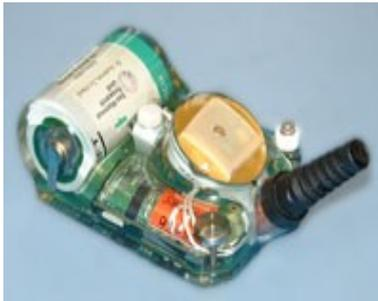
**Capteur utilisant le GPS + GSM**
